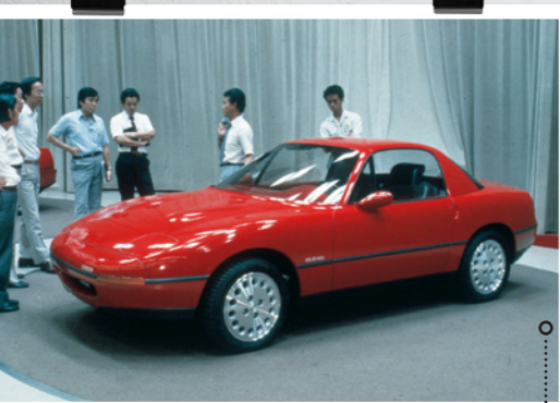
Une compétition interne aux studios de design de Mazda fut organisée en 1984 pour déterminer le dessin du futur coupé sportif léger. Le vainqueur fut le concept à moteur avant et roues arrière motrices du studio américain. Sur cette photo, le roadster est équipé d'un hard-top.
