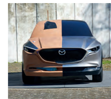
La maquette finie grandeur nature pèse environ 1 500 kg (structure métallique comprise) – un poids supérieur, dans certains cas, à celui du modèle de série.
